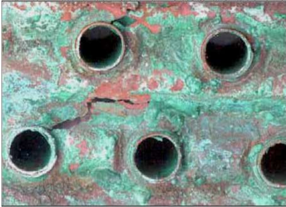
ŞEKİL 3: 500 SAAT NÖTR TUZ PÜSKÜRTME TESTİNDEN SONRA BAKIR-BAKIR BATARYA DETAYI
