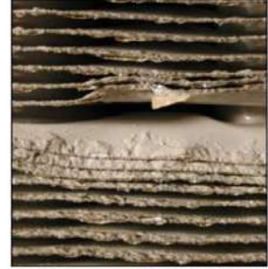
ŞEKİL 6: KANAT KENARI KOROSYONU, ÖNCEDE KAPLANMIŞ ALÜMİNYUM
