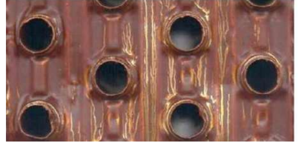
ŞEKİL 11: DALDIRMA-FIRINLAMA KAHVERENGİ FENOLİKLI BATARYA TESTİ
