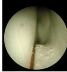
ŞEKİL 5: İPLİKSİ KOROSYON, ÖNCEDE KAPLANMIŞ ALÜMİNYUM
